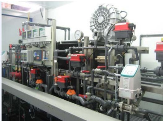
Planta pilot d'un bioreactor de membrana
