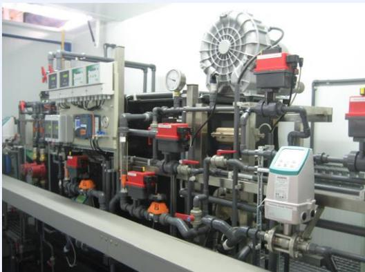
*Planta piloto de bioreactor de membrana (MBR)*
